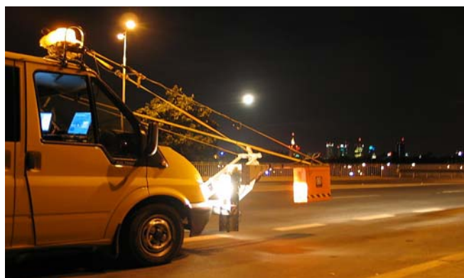
Rys. 1. System pomiarowy z umieszczoną w wózku anteną typu ground-coupled o częstotliwości 400 MHz i anteną typu air-coupled o częstotliwości 1 GHz
